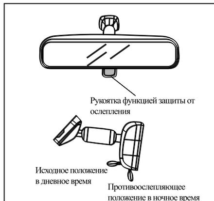
Перед началом движения необходимо отрегулировать внутренние и наружные зеркала заднего вида на оптимальный угол обзора, сохраняя зеркало заднего вида в чистоте.
