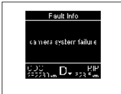
Когда система постоянно неисправна, индикатор неисправности системы будет гореть желтым светом, прибор отобразит сообщение «Сбой системы камеры», а изображение исчезнет через 5 с. Эффект отображения счетчика следующий.
