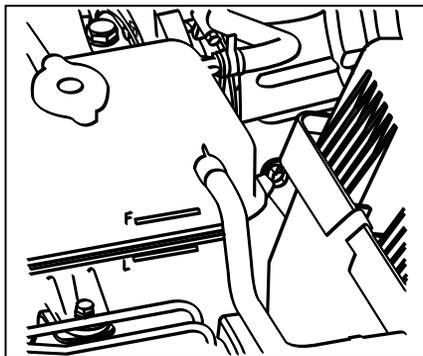
8. Проверьте уровень охлаждающей жидкости. Проверьте уровень охлаждающей жидкости в расширительном бачке. Если уровень жидкости ниже нижней границы отметки L, добавьте охлаждающую жидкость. Добавляемая охлаждающая жидкость не должна превышать верхний предел метки расширительного бачка F. Проверьте уплотнение и рабочее состояние давления крышки расширительного бачка.
