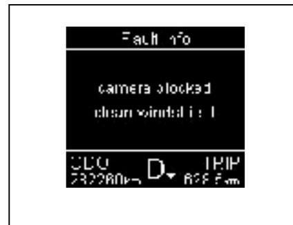
Когда камера заблокирована, индикатор неисправности системы будет желтым и всегда ярким. В то же время прибор отобразит сообщение «Камера заблокирована, очистите лобовое стекло». Графика исчезает через 5 секунд. Эффект отображения инструмента следующий.
